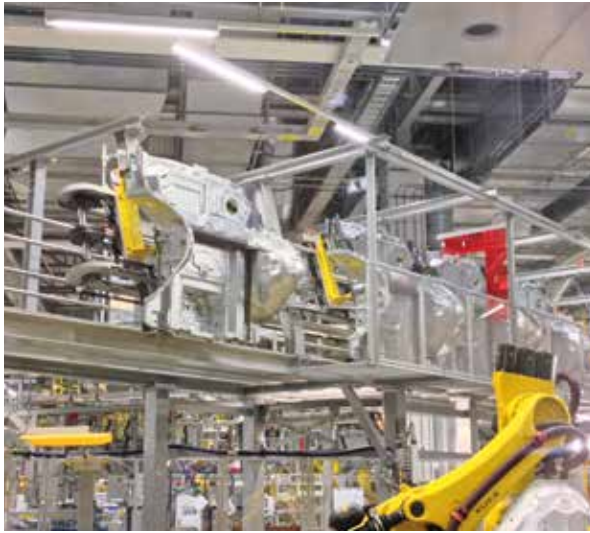
Ein Stauförderbänder für den Transport der Bodengruppe
